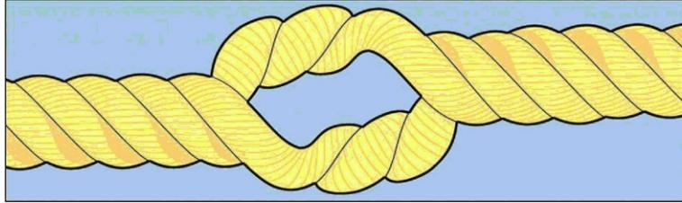
**Bild C.8 — Vollständige Deformation**
