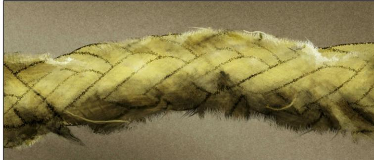
Bild C.9 — Äußerer Abrieb
