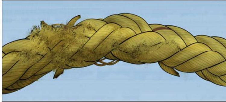
**Bild C.11 — Mechanischer Schaden**
